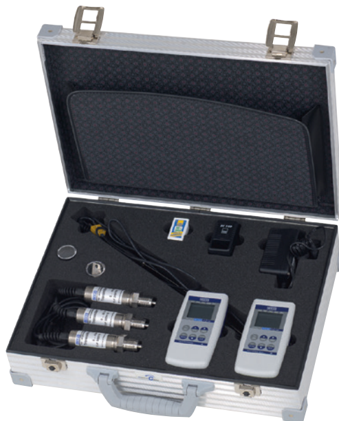
Ejemplo de maletín de mantenimiento (temperatura y presión)
