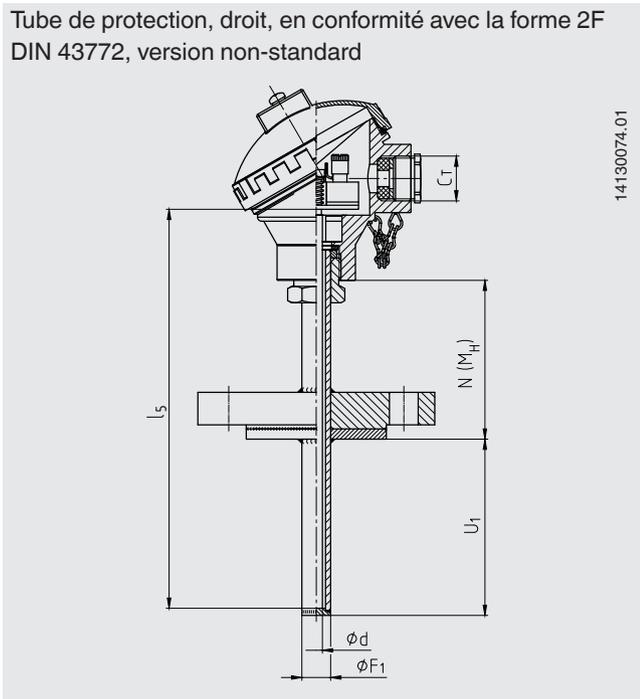
■ Tube de protection en conformité avec DIN 43772, couvercle en tantale avec disque de bride en tantale, tube de protection de support : acier inox
