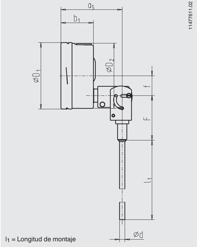
l<sub>1</sub> = Longitud de montaje
