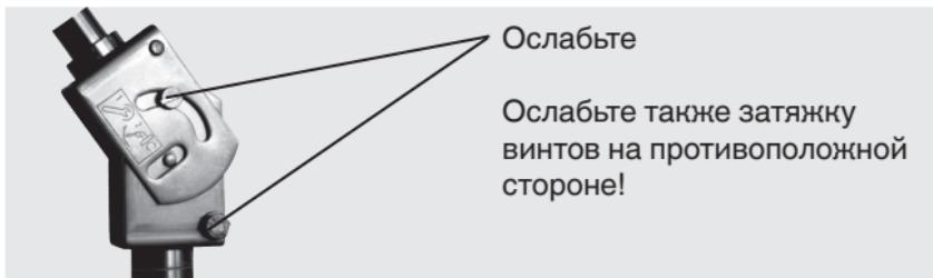
3. Установите индикатор в требуемое положение, затяните болты с шестигранной головкой и винты со шлицом, после чего тщательно затяните контргайку или накидную гайку.
