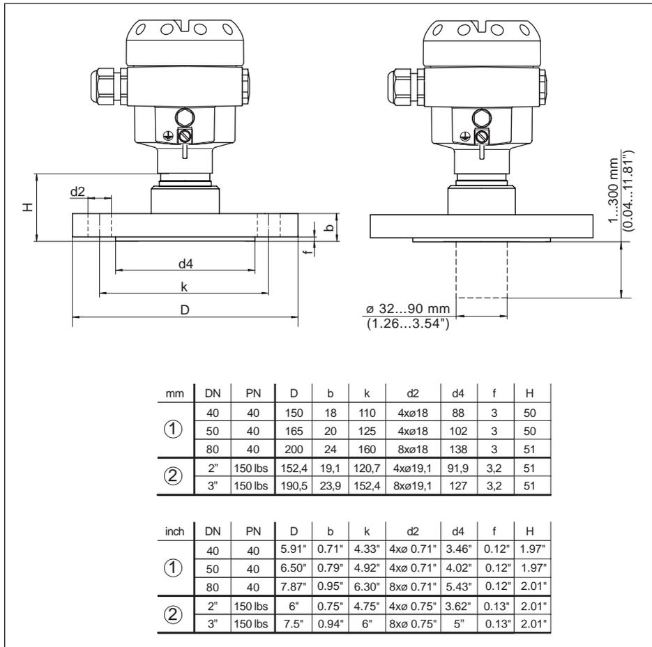
Fig. 43: CPT-2x, conexão com flange
