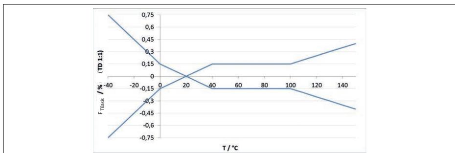
Fig. 33: Erro de temperatura básico  $F_{TBasis}$  com TD 1 : 1
