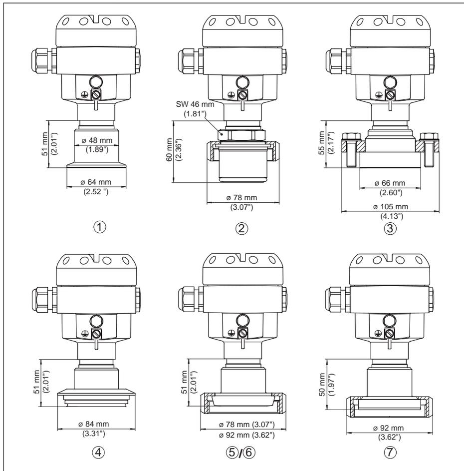
Fig. 42: CPT-2x, conexão asséptica
