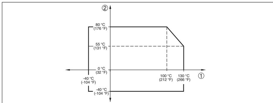
Fig. 35: Redução de temperatura CPT-2x, modelo até +130 °C (+266 °F)
