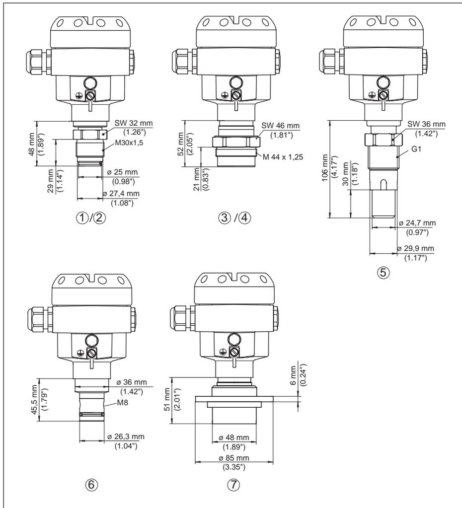
Fig. 44: CPT-2x, conexão de tubo
