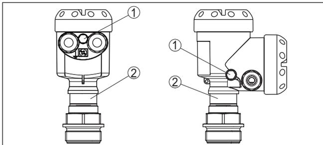
Fig. 14: Posição do elemento de filtragem - Passagem hermética
