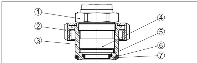
Fig. 30: CPT-2x, Estrutura conexão asséptica com porca de capa ranhurada
