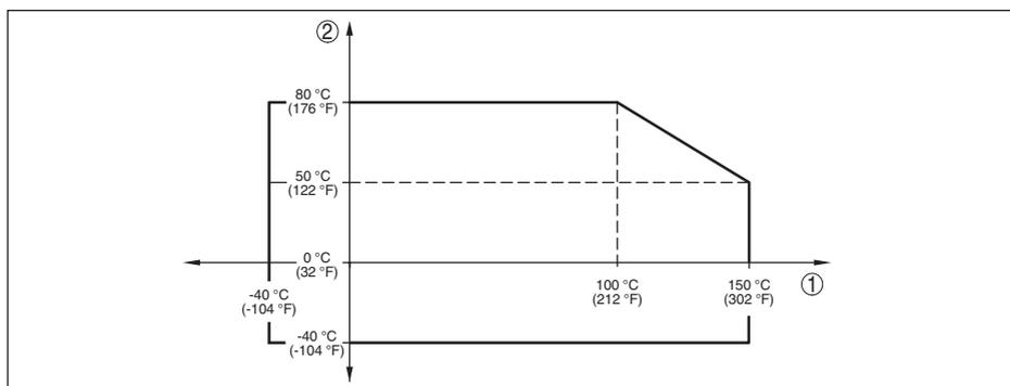
Fig. 36: Redução de temperatura CPT-2x, modelo até +150 °C (+302 °F)
