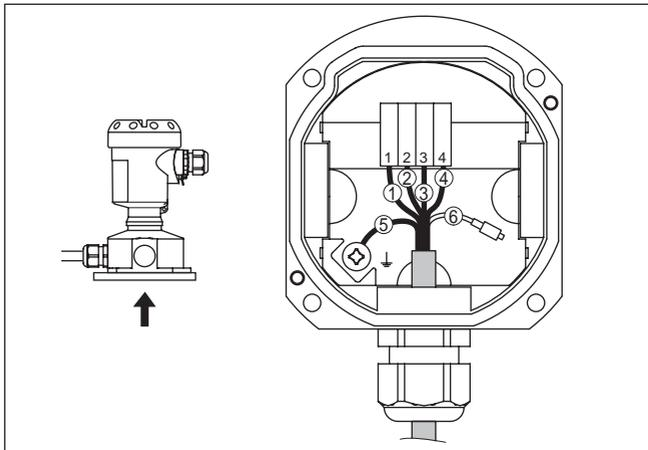
Fig. 25: Conexão do sensor na base da caixa
