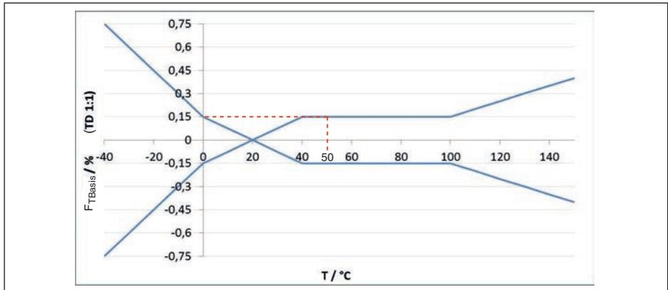
Fig. 37: Cálculo do erro de temperatura básico para o exemplo acima  $F_{\text{TBasis}} = 0,15\%$ :
