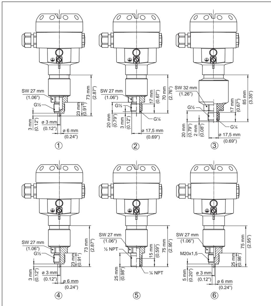
Fig. 40: CPT-2x, conexão rosca não embutida na frente
