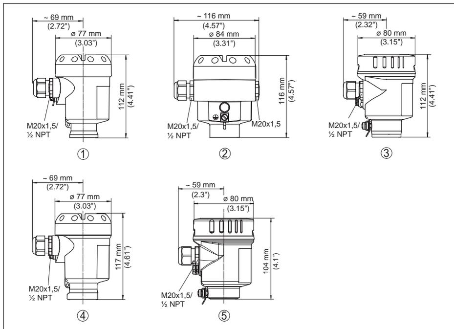
Fig. 38: Modelos da caixa com grau de proteção IP66/IP67 e IP66/IP68 (0,2 bar)
