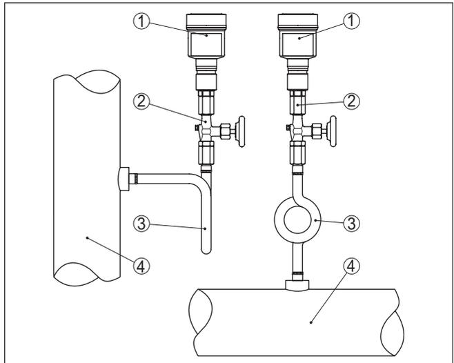
Fig. 16: Arranjo de medição na medição da pressão do processo de vapores em tubos
