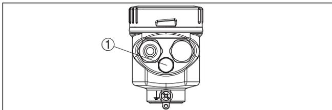
Fig. 13: Posição do elemento de filtragem - Modelo IP69K
