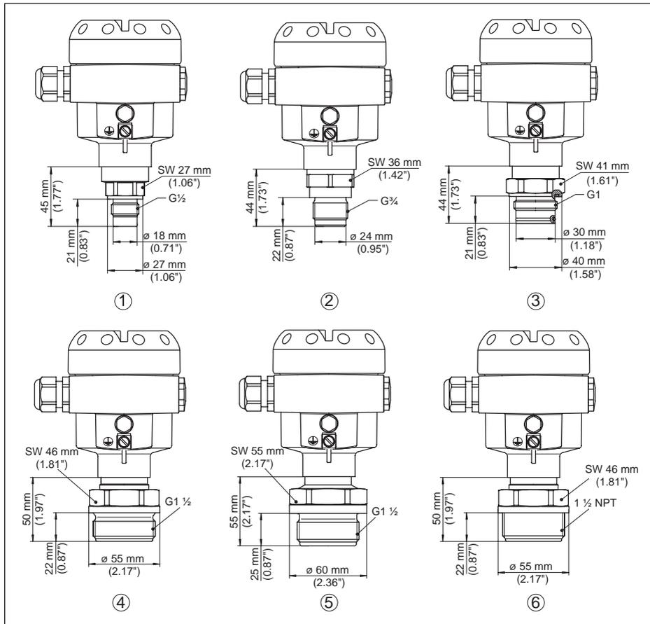
Fig. 41: CPT-2x, conexão rosca embutida na frente
