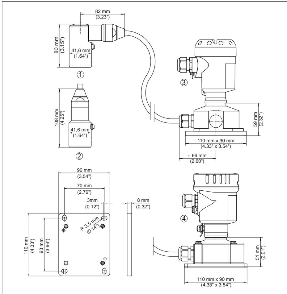
Fig. 39: Modelo IP68 com caixa externa
