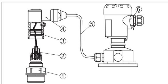
Fig. 31: CPT-2x como modelo IP68 de 25 bar e saída lateral do cabo, caixa externa
