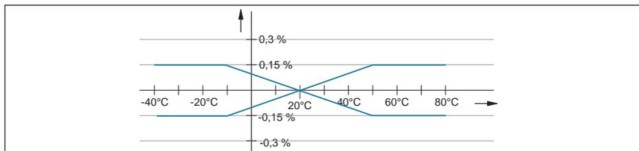
Fig. 34: Alteração térmica da saída de corrente
