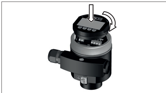
Рис. 38: Установка модуля индикации и настройки в отсеке электроники однокамерного корпуса
