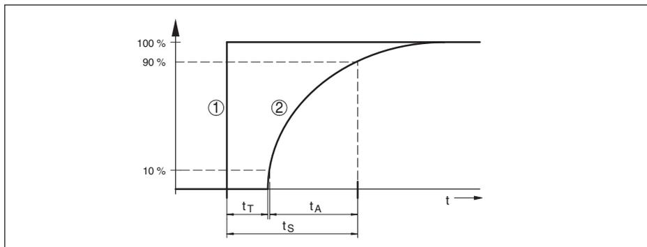
Figura 18: Brusca variazione della grandezza di processo.  $t_T$ : tempo morto;  $t_A$ : tempo di salita;  $t_S$ : tempo di risposta del salto
