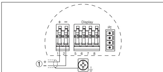
Figura 7: Schema elettrico custodia a una camera
