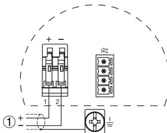
Figura 10: Schema di allacciamento custodia a due camere
