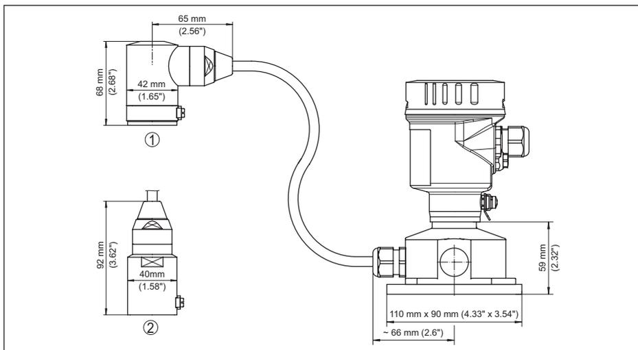
Figura 26: Esecuzione IP 68 con custodia esterna - esecuzione in acciaio speciale
