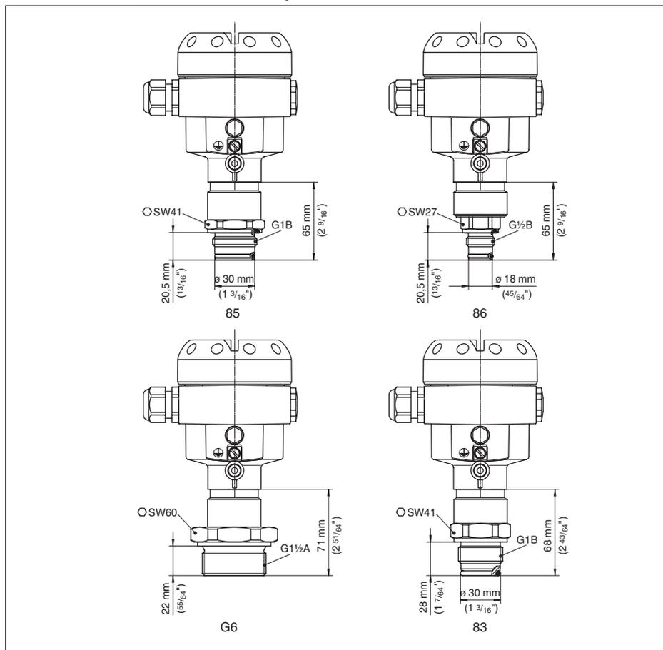
Figura 28: IPT-1\* Vers. 3.0 85 = G1 A affacciato 0 ... 0,4 bar e 0 ... 1,6 bar, 86 = G $\frac{1}{2}$  A affacciato > 1,6 bar, 84 = G1 A affacciato fino a 150 °C secondo EHEDG 0 ... 0,4 bar e 0 ... 16 bar
