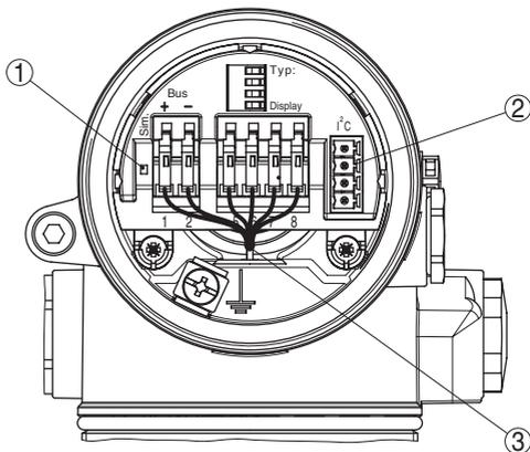
Figura 8: Vano dell'elettronica con custodia a due camere
