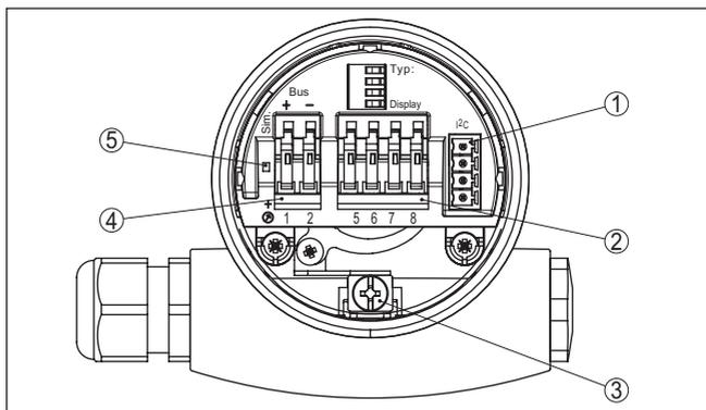
Figura 6: Vano dell'elettronica e di connessione della custodia ad una camera
