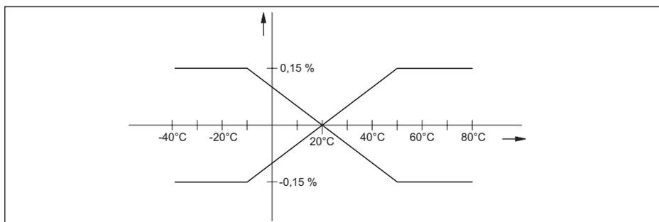
Figura 19: Variazione termica uscita in corrente
