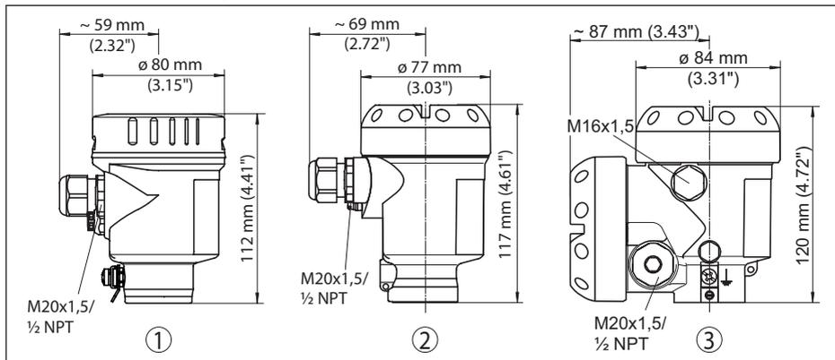
Figura 24: Le differenti custodie con grado di protezione IP 66/IP 68 (0,2 bar) - con tastierino di taratura con display incorporato l'altezza della custodia aumenta di 9 mm/0.35 in
