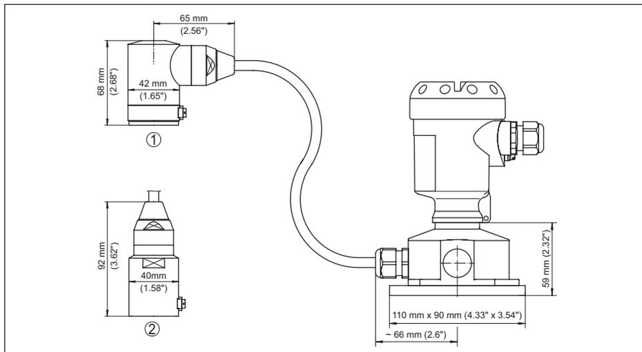
Figura 25: Esecuzione IP 68 con custodia esterna - esecuzione in resina
