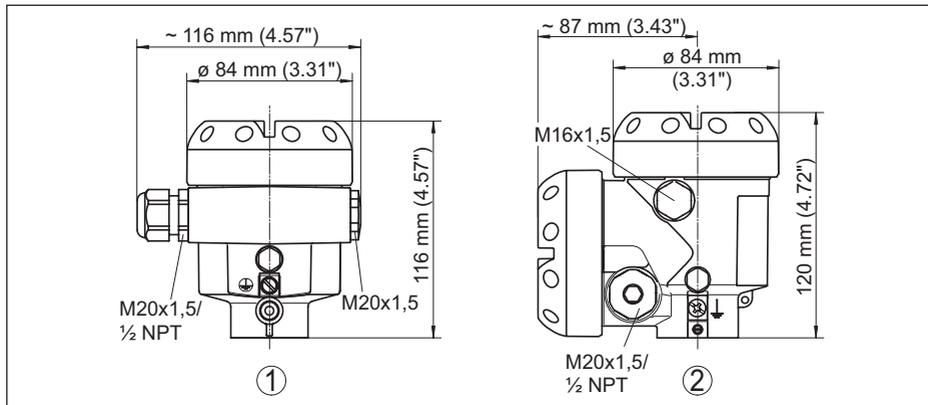
Figura 23: Le differenti custodie con grado di protezione IP 66/IP 68 (0,2 bar) - con tastierino di taratura con display incorporato l'altezza della custodia aumenta di 9 mm/0.35 in
