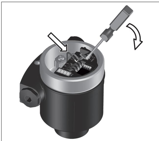
Figura 5: Operazioni di collegamento 6 e 7
